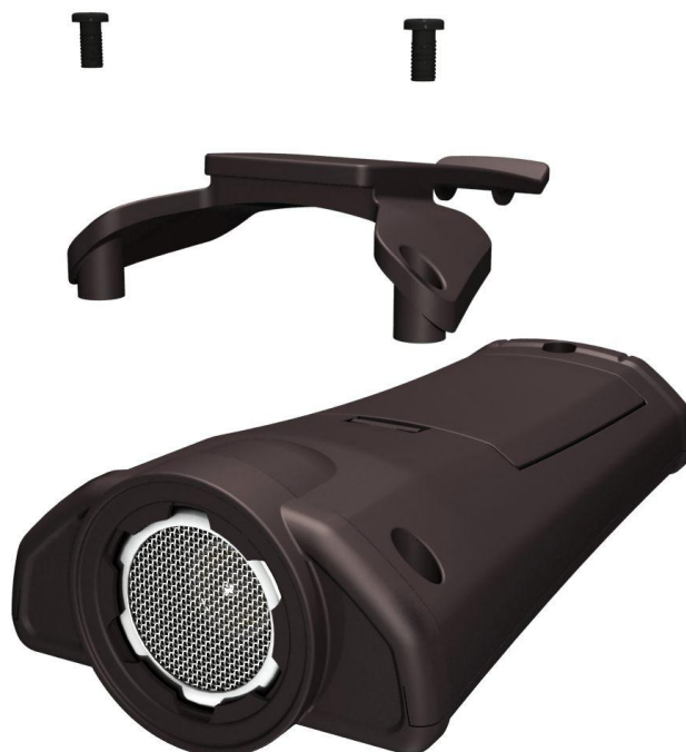
Рисунок 3 – схема установки клипсы
